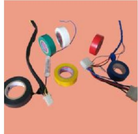
Если шнур разорван посередине, то нужно зачистить от изоляции только один провод и постараться соединить его. Если этого сделать нельзя, то разрезают второй провод, а после этого соединяют оба провода шнура.
