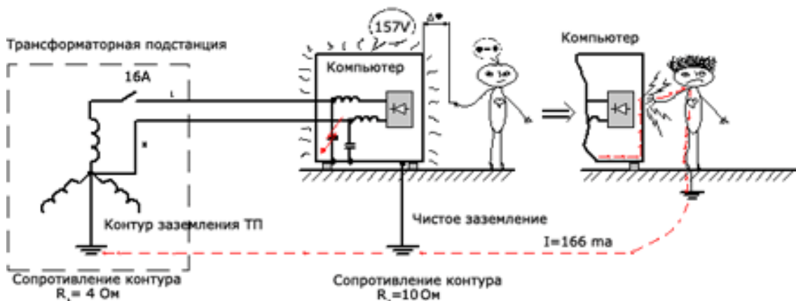
Рис.1. Применение выделенного контура заземления на компьютерное оборудование очень опасно.
