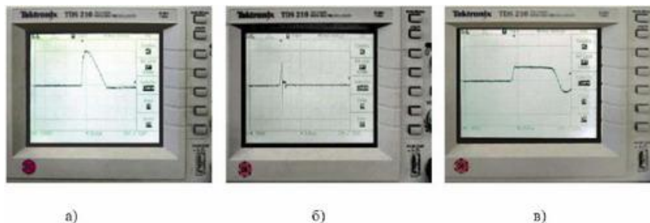
Рис. 6 а) Волна напряжения формы 1.2/50 мкс, б) Форма импульса после срабатывания разрядника, в) Форма импульса после срабатывания варистора.
